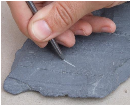
Tonminerale werden von einem Stahlnagel geritzt (im Photo das Gestein Schiefer stellvertretend für Mergel).
